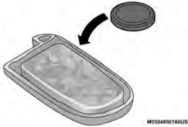
Remplacement de la pile de la télécommande
