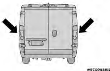
Emplacements des capteurs radar
