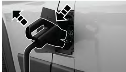
Retrait du connecteur de charge de l'entrée de chargement du véhicule
