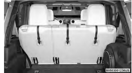
Montage de la courroie d'attache (modèles à 4 portières sans accoudoir central)
