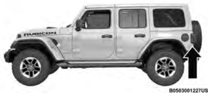
Emplacement du radar du système de surveillance des angles morts (côté gauche illustré)
