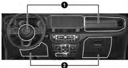
Emplacement des sacs gonflables avant et des protège-genoux d'impact
