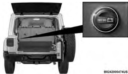
Prise de courant de l'espace de chargement arrière
