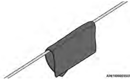
Couverture lourde sur le câble
