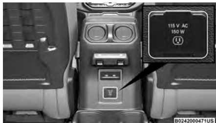
Commande électrique Onduleur
