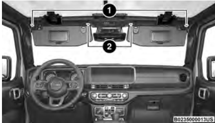
Emplacements des vis Torx à l'intérieur
