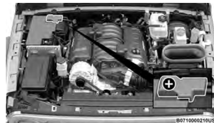
Borne positive (+) de la batterie (moteur de 6,4 L)
