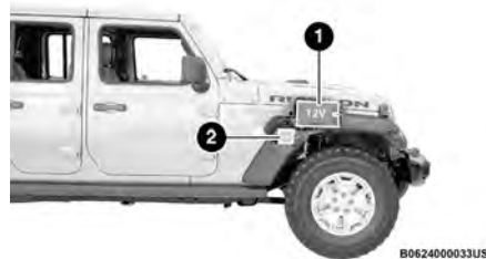
Emplacement des batteries
