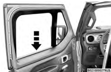
Poussez vers le bas pour mettre en place complètement la demi-portière supérieure
