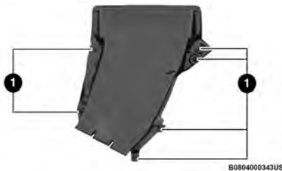
Première chambre de séparation d'eau
