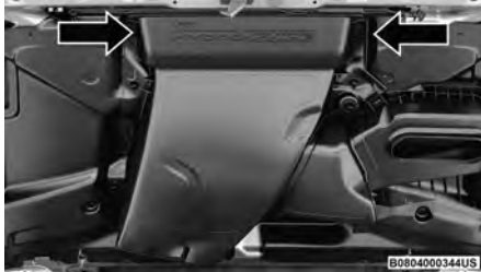
Retrait de la première chambre de séparation d'eau
