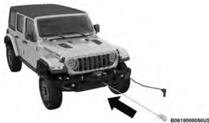
Rembobinage du câble en fibres synthétiques
