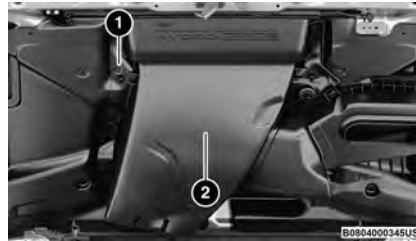
Première chambre de séparation d'eau
