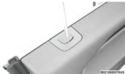
Placez l'outil dans l'orifice d'entretien du bouchon pour le retirer
