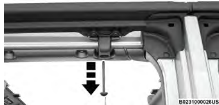
Retirer les vis du dessous de l'encadrement
