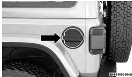
Trappe du réservoir de carburant
