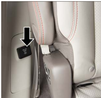
Onduleur d'alimentation de 115 Volts
