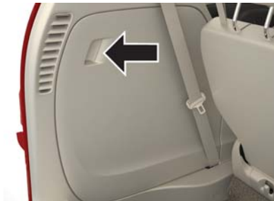
Emplacement de l'équipement de levage par cric
