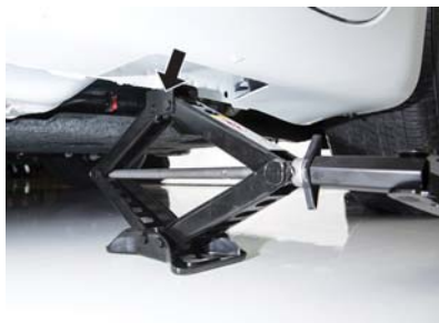
Emplacement de levage arrière engagé
