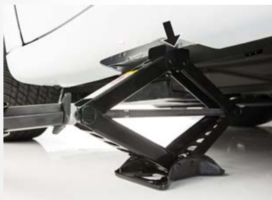
Emplacement de levage avant engagé
