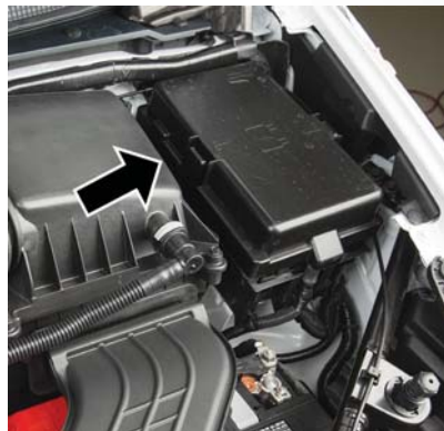
Centrale de servitudes
