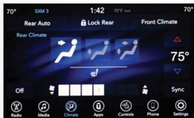
Affichage des commandes arrière du bloc de commandes du système de chauffage-climatisation à commande automatique avant du système Uconnect 4
