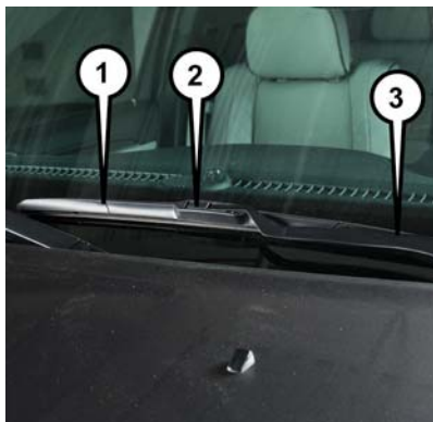
Balai d'essuie-glace avec patte de déverrouillage en position verrouillée
