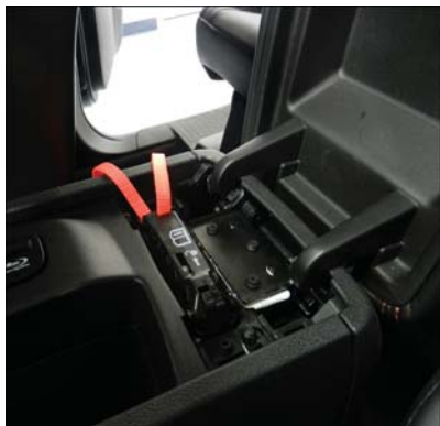
Retrait du couvercle du levier de déverrouillage de position de stationnement manuel
