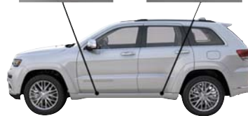
Emplacements de levage
