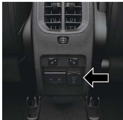
Onduleur d'alimentation de la console centrale arrière
