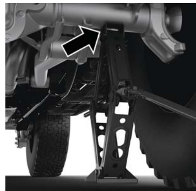
Emplacement d'engagement du cric avant
