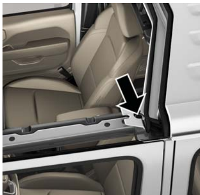
Emplacement des vis à tête Torx – côté conducteur illustré
