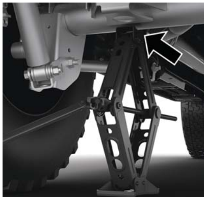
Emplacement d'engagement du cric arrière
