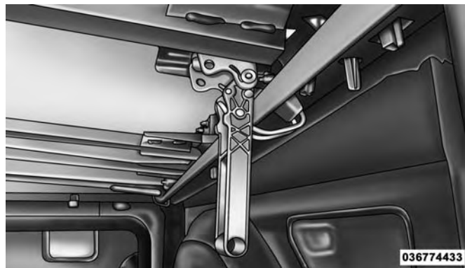
Position de serrage partiel
