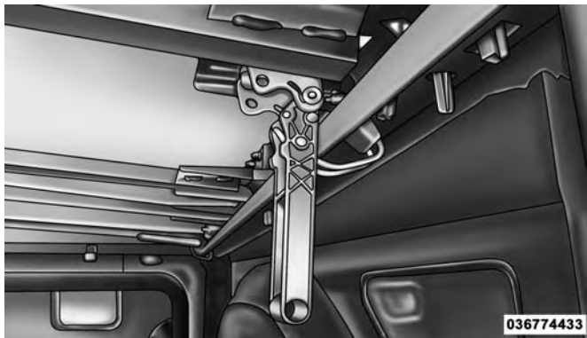
Position de serrage partiel
