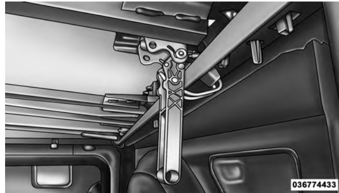
Position de serrage partiel
