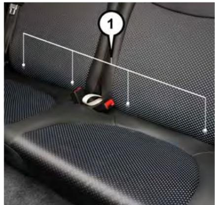
Emplacements d'ancrage du système LATCH
