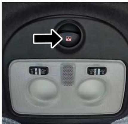
Commutateur de toit ouvrant à commande électrique
