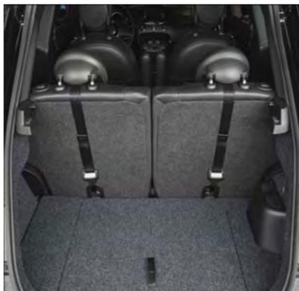
Montage de la courroie d'attache du siège arrière
