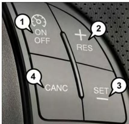
Boutons de commande du contrôle électronique de vitesse
