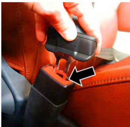
Insertion de la languette dans la boucle de la ceinture
