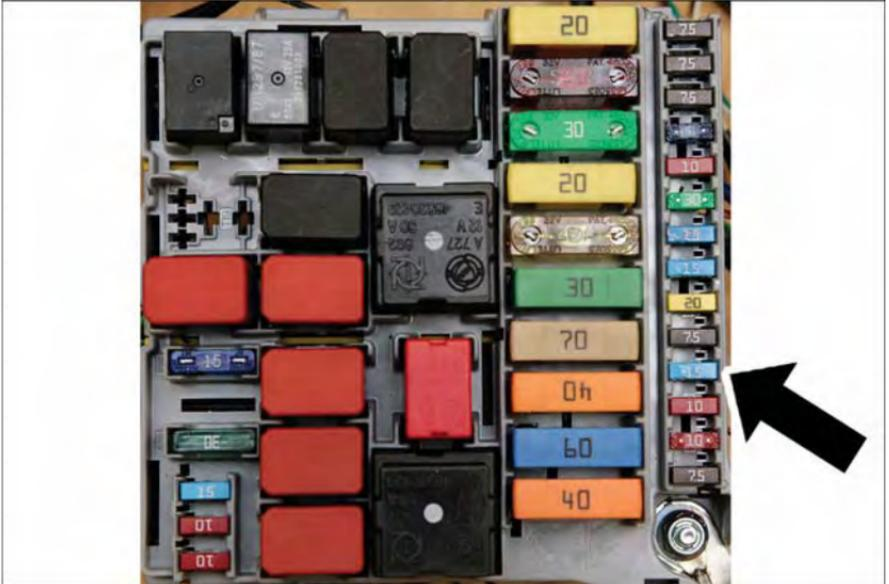
Fusible de 15 A bleu, F15 pour allume-cigare et prise de courant à l'avant de la console
