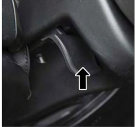
Levier d'inclinaison et de réglage télescopique
