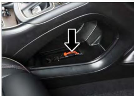
Attache du levier de déverrouillage de position de stationnement manuel
