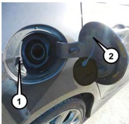
Trappe du réservoir de carburant et crochet pour cordon de retenue du bouchon du réservoir de carburant
