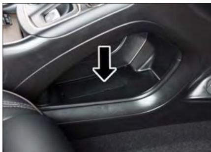
Couvercle du levier de déverrouillage de position de stationnement manuel
