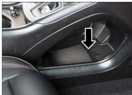
Emplacement du levier de déverrouillage de position de stationnement manuel
