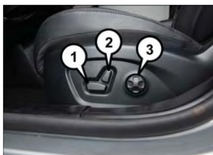
Commutateurs de siège à réglage électrique
