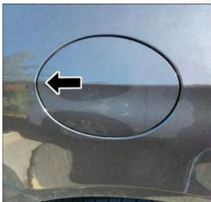
Dispositif de déverrouillage de la trappe du réservoir de carburant
