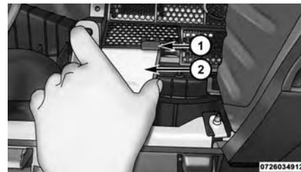
Ouverture de la trappe d'accès au filtre à air
