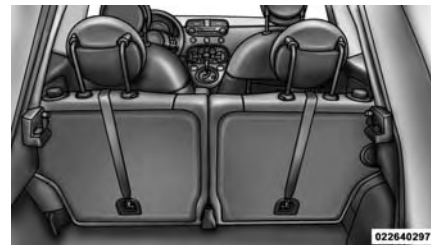
Montage de la courroie d'attache de la banquette arrière
