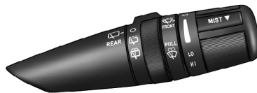
Levier de commande d'essuie-glaces et de lave-glace
