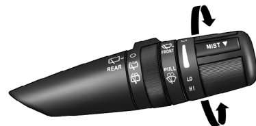
Commande des essuie-glaces de pare-brise
