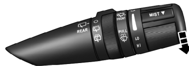
Commande d'essuyage antibruine
