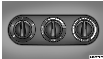
Commandes de chauffage-climatisation
