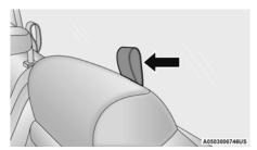
**Center Tether Anchorage Over Head Rest**
