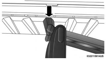
**Aligning Gate To Slots**
