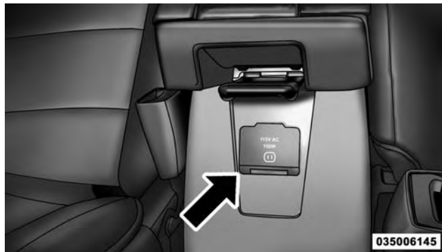
115 Volt Power Outlet
